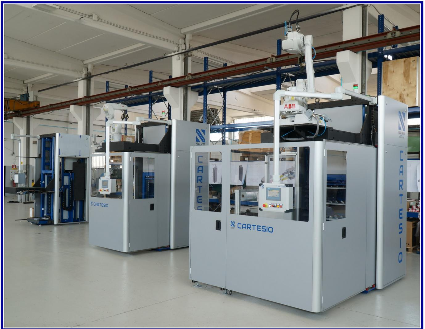
**CARTESIO** è la soluzione per carico/scarico su macchine CNC con robot antropomorfo a posizionamento dinamico.
