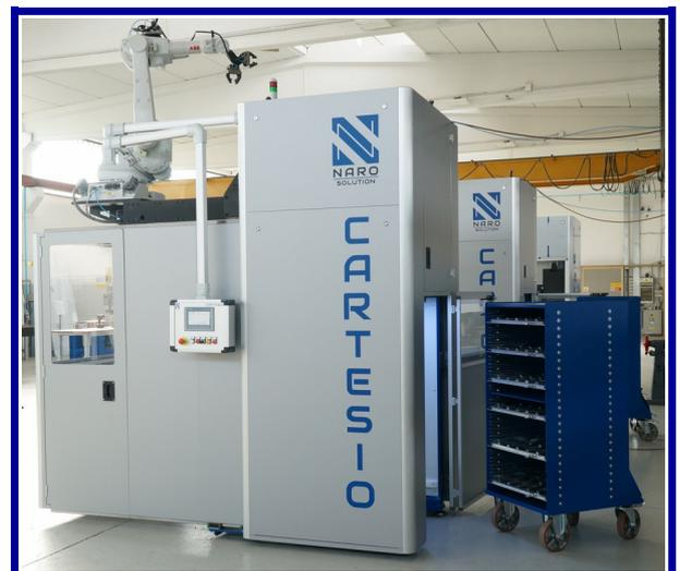
L'impianto **CARTESIO** è stato sviluppato per la movimentazione di pezzi con peso (consigliato) fino a 10 kg per asservimento di macchine utensili CNC come torni, dentatrici, centri di lavoro e rettifiche di ingranaggi/alberi.
